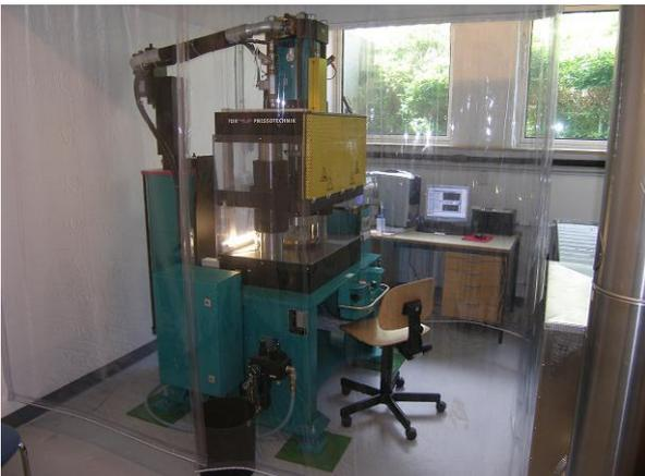
Abb. 13: Zur Sinterung von Halbleitern wird eine 100 t-Sinterpresse verwendet. Modifiziertes Standard Equipment (Tox Pressotechnik).
