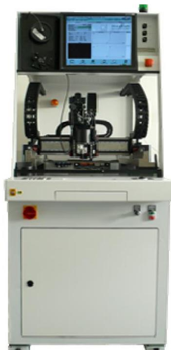
**Abb. 3: Ein Wedge-Bonder der Fa. Hesse Mechatronics Typ BJ939 wird für die Entwicklung der Kupfer-Bändchenbondtechnik im Fraunhofer ISIT benutzt. Die Maschine wird zur Kontaktierung von Leistungsbau-elementen eingesetzt und verarbeitet Aluminium- und Kupfer-Runddraht sowie Bändchen mit zwei unterschiedlichen Bondköpfen.**
