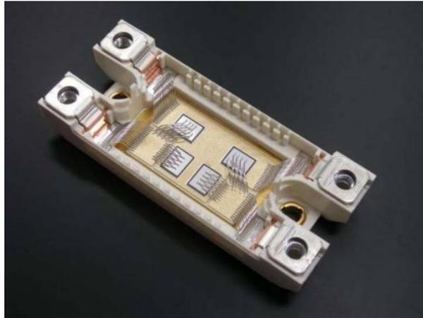
Abb. 63 Diodenmodul DSP
