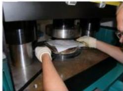
2. Einlegen des Sinternutzens unter die Sinterpresse
