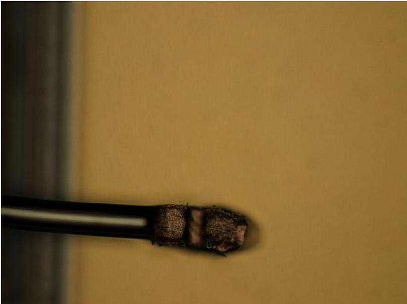
Abb. 94: beschichteter Kupferdraht Ø 50 µm wurde mit einem Crossgroove-Tool auf eine DCB mit Gold-Finish gebondet
