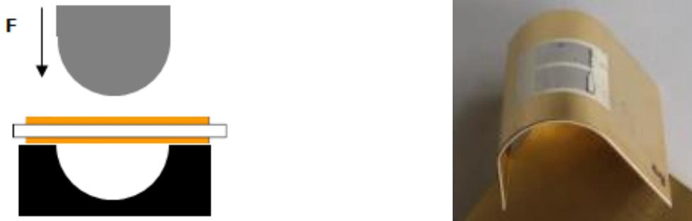
Abb. 51 Prinzipdarstellung eines Dornbiegetest und Prüfling
