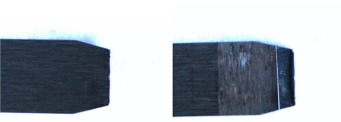
Abb. 33: Messer nach 13.800 Schweißungen (Vorder- und Rückansicht).
