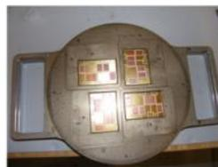
4. Entnommenes Sinternutzen nach dem Sinterprozess
