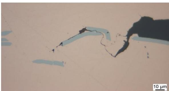
Abb. 18: Detail einer Kupfer Bändchenbondierung auf DCB. Die chem. Ni/Au Beschichtung wird durch die Krafteinleitung zerrüttet.
