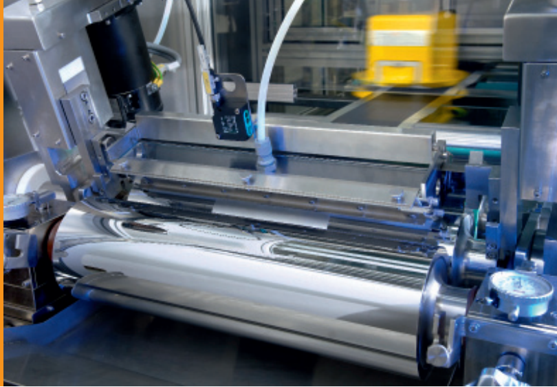
Traversierende berührungslose Schichtdickenkontrolle (gelb) am Technikums-Coater
