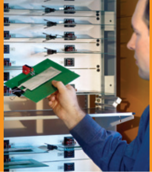
Messtechnik zur elektrischen Charakterisierung von LiPo-Testzellen
