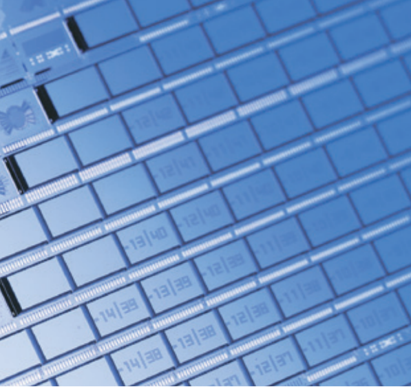
Waferausschnitt mit vakuumverkapselften Drehratensensoren
