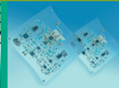
Flexible Elektronik für ein Laktat- Sensorsystem
