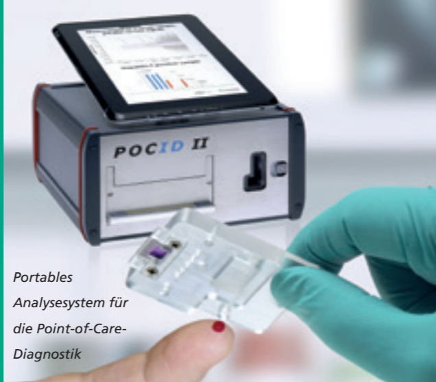
Membransensorchip, elektrisch und fluidisch kontaktiert in einer Durchfluss-Reaktionskammer
