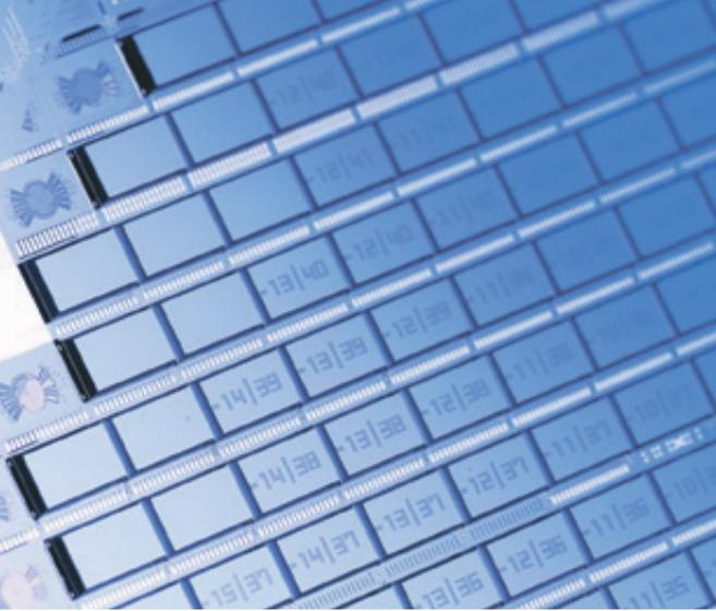
*Waferausschnitt mit vakuumverkapselten Drehratensensoren*
